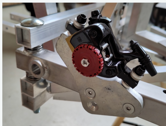
Pose de l'étrier sur le chassis
