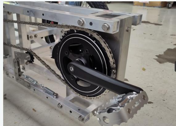
Une fois les 4 vis en place, serrer les écrous. Lors du serrage, repositionner les entretoises si besoin pour les centrer et les aligner (plus esthétique). Une fois les entretoises correctement positionnées, serrer fermement les écrous.
