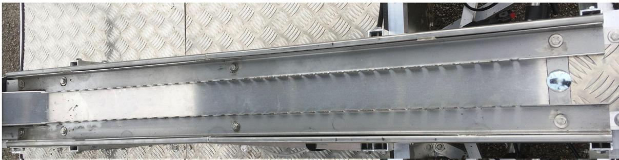
Réaliser le même montage pour les deux glissières arrière CHO32. Elles se fixent sur la tôle supérieure porte bagage CHO25 avec 3 vis M6x40 par glissières.
