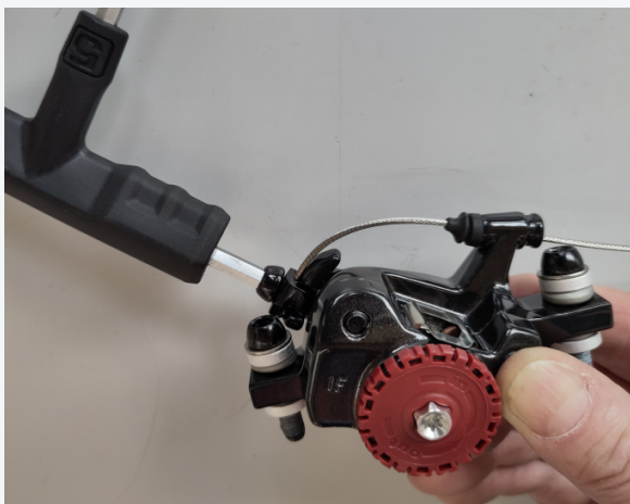
Montage du câble dans l'étrier
