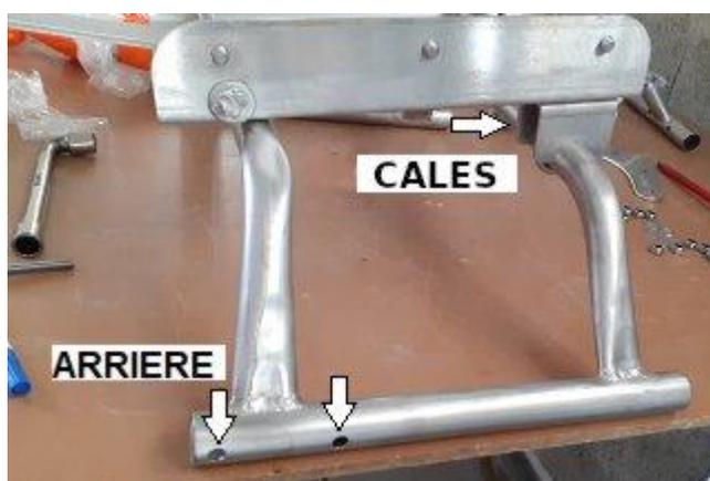
Les 4 tiges en U permettent de solidariser l'assise avec l'embase. Utiliser les U longs du côté des cales.
