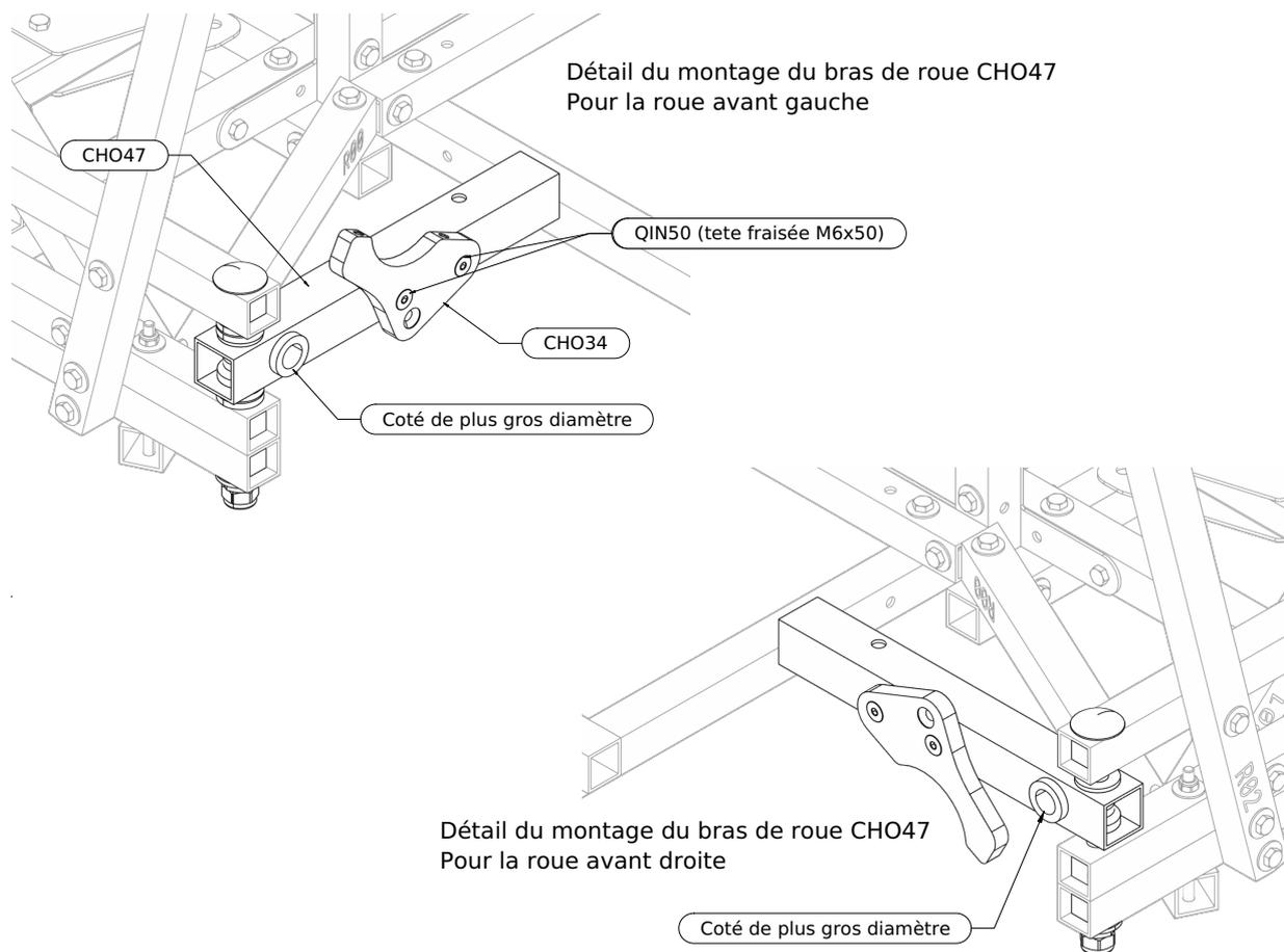
Fixez les supports de frein CHO34 tel qu'indiqué sur le dessin. Celui du frein gauche est orienté vers le haut, celui du frein droit est orienté vers le bas. Chaque support est fixé avec deux vis tête fraisée M6x50 (QIN50) et deux écrous frein M6 (QIN06).
