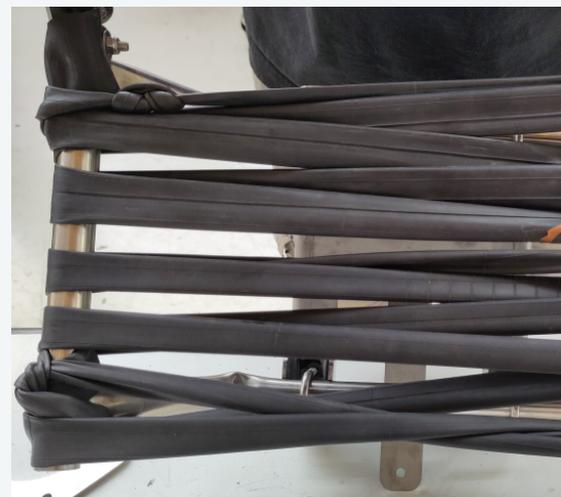
Attention, s'il est nécessaire de tendre à chaque tour de tissage pour que la chambre à air ne puisse se déplacer ou se détendre, il ne faut pas serrer trop fort, car l'effet élastique cumulé, tour après tour, pourrait déformer les barres du siège. Trouver la juste mesure pendant l'opération en surveillant l'état des barres. Par la suite, la mise en oeuvre de la toile a tendance à rendre les chambres à air plus fermes qu'au moment du tissage.
