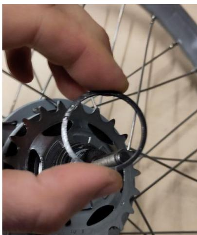
Placer sur la gorge supérieure en maintenant avec un doigt une extrémité et avec un petit tournevis plat, faire un effet de levier pour placer l'autre extrémité dans la gorge finale
