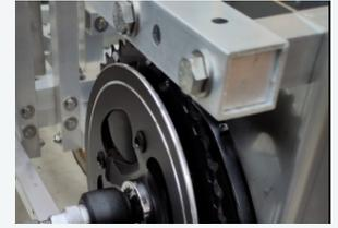
Le moteur se fixe avec des vis M8x140 (QIN28). Pour plus de facilité, commencer par une vis du haut (une fois cette première vis insérée, le moteur se retrouvera suspendu). Il peut être utile de se faire aider par une personne qui tiendra le moteur en place pour la première vis.
