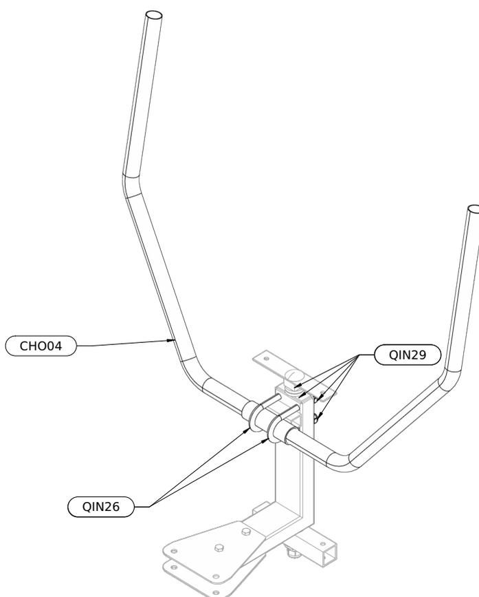
Utiliser les vis en U QIN26. L'inclinaison du guidon sera à ajuster après le placement du siège pour une position de conduite confortable (plus ou moins penché vers l'avant selon la taille du conducteur). Il faudra alors serrer fermement les 4 écrous pour bloquer son inclinaison.
